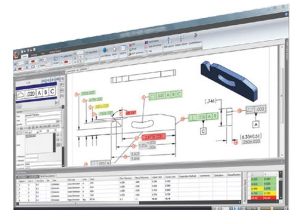
As características são automaticamente destacadas em verde, vermelho ou amarelo para mostrar instantaneamente quais estão dentro da tolerância, fora da tolerância ou ligeiramente dentro da tolerância.
